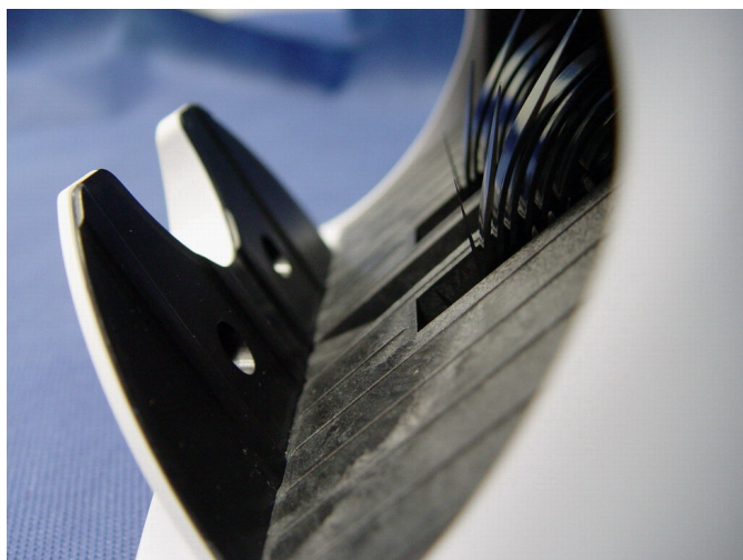
Упор приемного кармана новой конструкции Magner 15.
