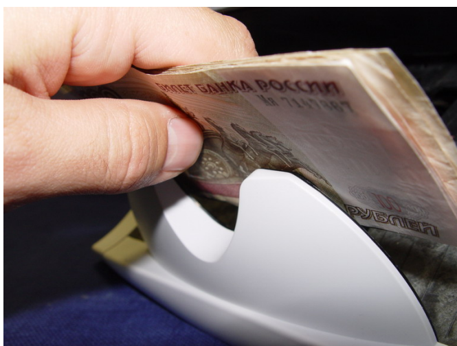
Упор приемного кармана новой конструкции Magner 15.
