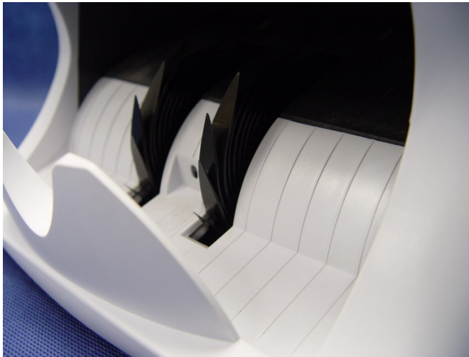
Тракт укладчика предыдущей конструкции Magner 15.
